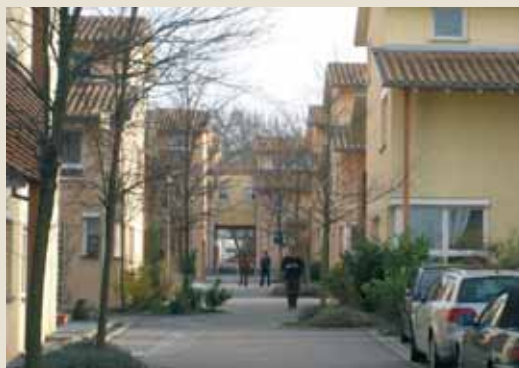
Creatieve en sierlijke ondiepe gootjes in het straatbeeld voeren het regenwater naar een gemeenschappelijke regenput voor toiletspoeling en tuinen. Foto Guy Dries
